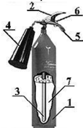
Рисунок 1 – Основные части переносного углекислотного огнетушителя.
